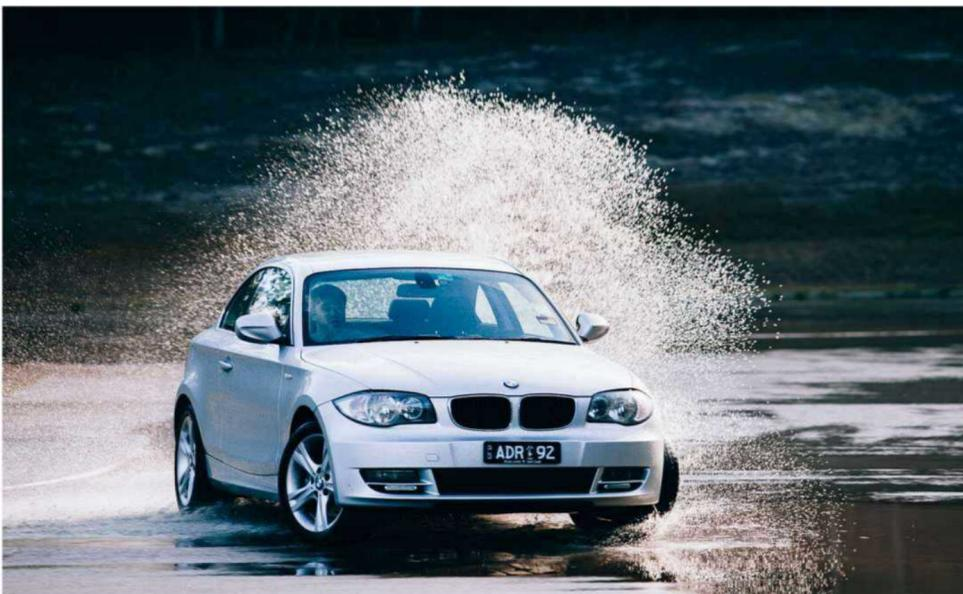
É o deslizamento do veículo sobre uma lâmina d'água! De início, a água freará o carro podendo alterar o rumo da direção, caso um lado aquaplanar antes do outro, logo depois, a tendência é isolar os pneus do solo, casando assim, o efeito "esqui", dessa forma o M.O perderá totalmente o controle do veículo – acelerar, fazer curvas ou dá uma outra direção qualquer.
